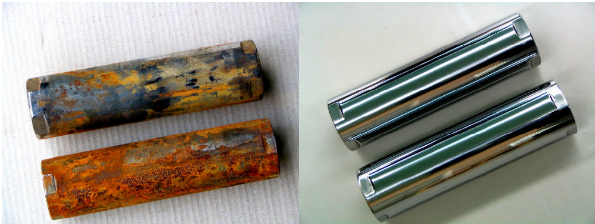
Плунжерный насос высокого давления для введения химических веществ в землю. Коррозия под воздействием химических веществ
