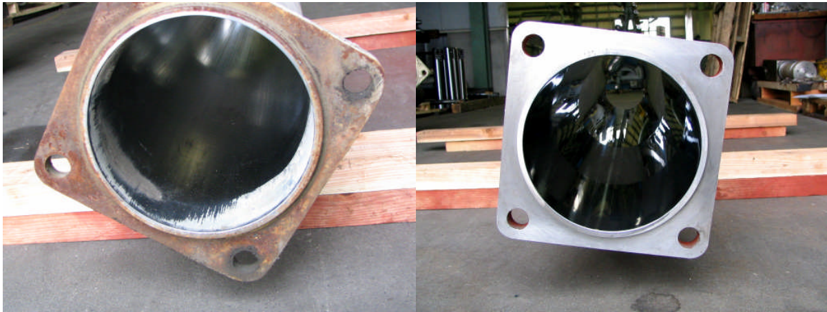
Цилиндр бетононасосового оборудования (слева : до обработки) (справа : после обработки)
