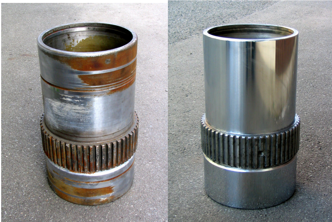
Деталь бетононасосного оборудования (слева : до обработки. Порча от воздействия бетона) (справа : восстановленный вид)
