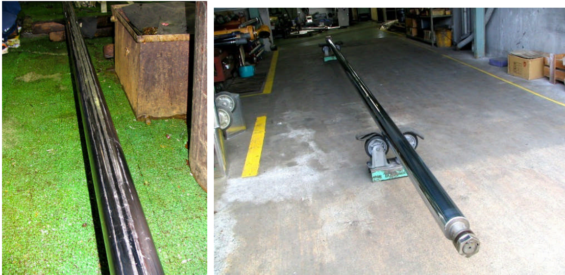
(слева: 6 метровый покраженный стержень погрузочного портового крана) (справа: восстановленный после хромирования )
